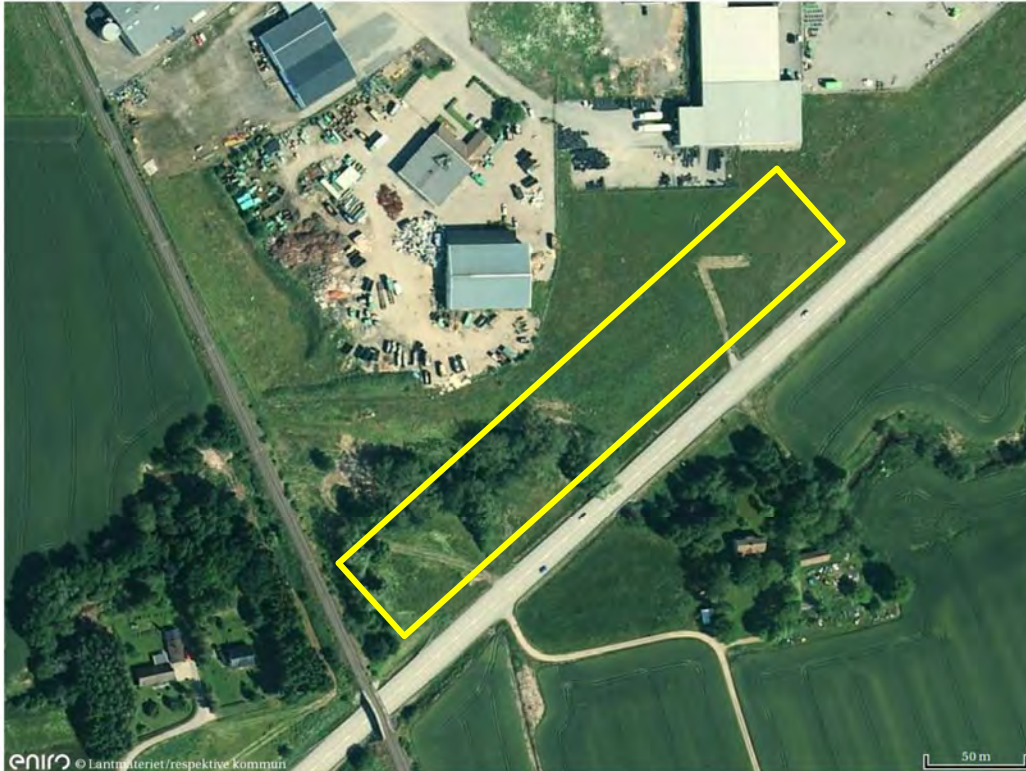
Figur 5 Möjlig placering av cirka 5 000 m 2 solfångare längs med E20 i nära anslutning till fjärrvärmecentralen i Vara. Rektangeln motsvarar cirka 15 000 m 2 mark.
